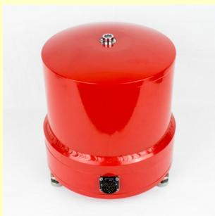
L' SS08 è un sismometro a banda larga facilmente trasportabile progettato per una rapida e semplice installazione. Può operare in un ampio range di temperature e condizioni atmosferiche.
